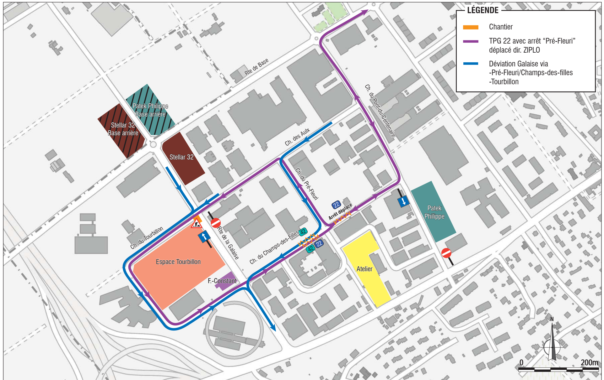
Figure 1 Schémas déviation - Etape de chantier 1
